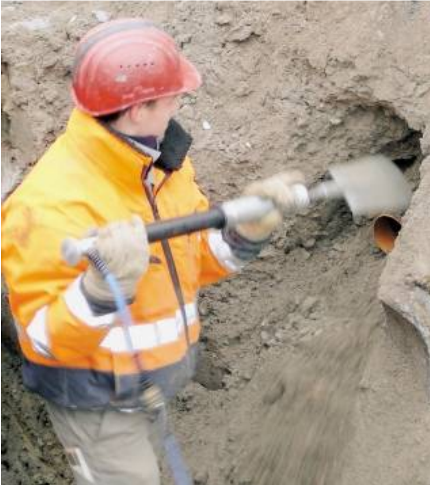
Kurz und stark: Der kurze Hammer für den Tiefbau verzichtet auf den T-Griff. Damit ist er handlicher als der gleich starke Turbo Spaten.
